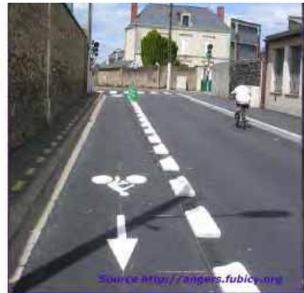
Exemple d'implantation d'un double sens cyclable de type piste cyclable
